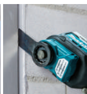
Corte de massa de vidraceiro, silicone.
