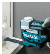
Trabalhos de abertura de portas.
