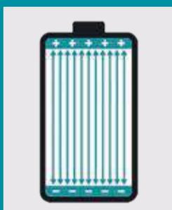
A tecnologia Tabless resulta numa vida útil mais longa da bateria e numa saída de energia sustentada, mesmo em aplicações pesadas. Esta versão oferece propriedades superiores de transferência e geração de calor em comparação com os designs de células electroquímicas convencionais, menor resistência interna, carregamento mais rápido e maior resistência à deformação mecânica.
